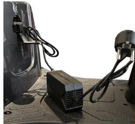
**HINWEIS:** Verbinden Sie immer zuerst das Ladegerät mit dem Akku/Fahrzeug. Anschließend stecken Sie den Netzstecker in die Steckdose!
